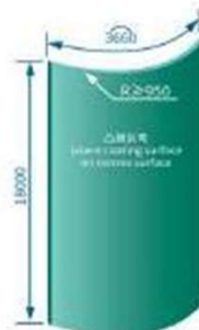
单曲 (凸) 弯钢化玻璃最大加工尺寸 (单位 mm) Processing capacity of single curved tempered glass (mm)
