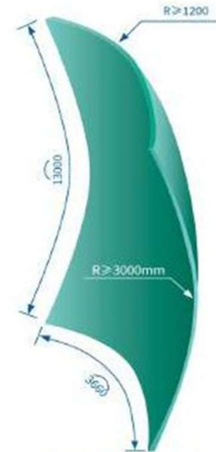
双曲弯钢化最大加工尺寸 (单位 mm) Processing capacity of Double-curved tempered glass (mm)
