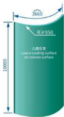
单曲(凸)弯钢化最大加工尺寸(单位mm) Processing capacity of single curved tempered glass(mm)
