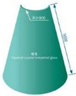
扇形弯钢化玻璃最大加工尺寸 (单位 mm) Processing capacity of tapered curved tempered glass (mm)
