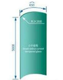
小半径弯钢化玻璃最大加工尺寸 (单位 mm) Processing capacity of small radius curved tempered glass (mm)
